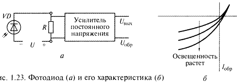
Рис. 1.23. Фотодиод (а) и его характеристика (б)
