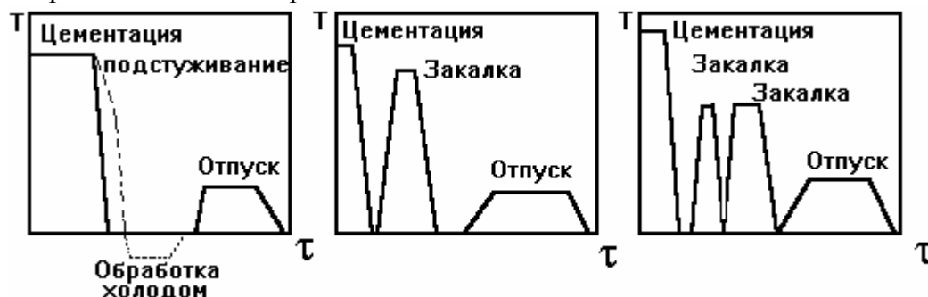
Рис. 49. Режимы термической обработки цементированных деталей.
