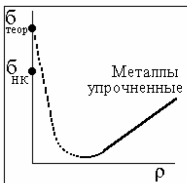
Рис. 5. Зависимость временного сопротивления растяжения \sigma разных металлических материалов от плотности дислокаций \rho см Е-3.
