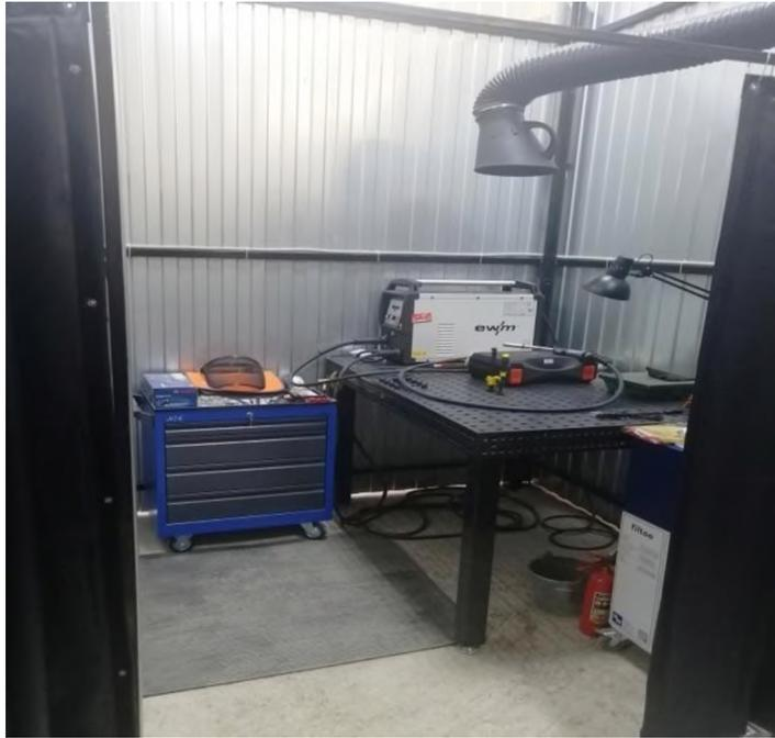
Сварочный аппарат: для аргонодуговой сварки EWM Tetrix230 AC/DC, для полуавтоматической сварки в среде защитного газа, EWM Picomig 355 Sinergi, для ручной дуговой сварки EWM Pico180
