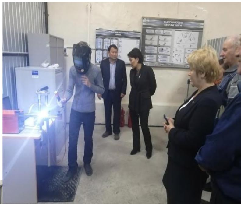
Сварочный тренажер для аргонодуговой сварки, для полуавтоматической сварки в среде защитного газа, для ручной дуговой сварки.
