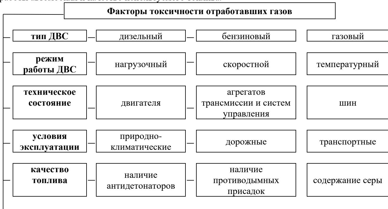
Вредные вещества при эксплуатации подвижных транспортных средств поступают в воздух с отработавшими газами, испарениями из топливных систем и при заправке, а так же с картерными газами. На выбросы оксида углерода значительное влияние оказывает рельеф дороги и режим движения автомашины. Так, например, при ускорении и торможении в отработавших газах увеличивается содержание оксида углерода почти в 8 раз. Минимальное количество оксида углерода выделяется при равномерной скорости автомобиля 60 км/ч.
