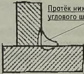
Протёк нижнего стыкового шва
