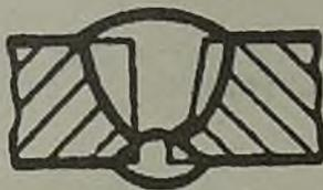
— «С11» — двусторонний стыковой шов с двумя симметричными скосами одной кромки;
