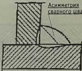
— **неравномерная ширина шва** — чрезмерное колебание ширины шва;
