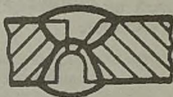
— «С15» — односторонний стыковой шов со скосом двух кромок;
