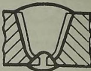
— «С20» — двусторонний стыковой шов с ломанным скосом двух кромок;
