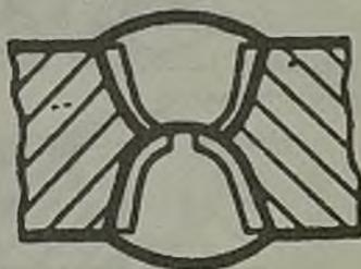
— «С23» — двусторонний стыковой шов с двумя симметричными ломанными скосами двух кромок;
