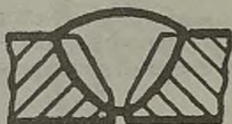
— «С16» — односторонний на остающейся или съемной подкладке стыковой шов со скосом двух кромок;
