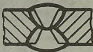
— «С22» — двусторонний стыковой шов с двумя симметричными криволинейными скосами двух кромок;
