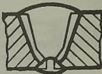
— «С21» — двусторонний стыковой шов с двумя симметричными скосами двух кромок;
