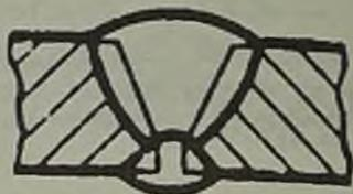
— «С19» — двусторонний стыковой шов с криволинейным скосом двух кромок;
