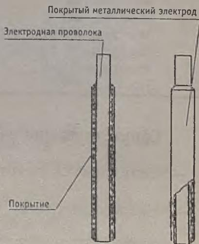
**Покрытые металлические электроды ручной дуговой сварки** предназначены для получения неразъемного сварного соединения путем совместного оплавления металлического электрода и основного металла с образованием общей сварочной ванны, а следовательно, сварного шва.
