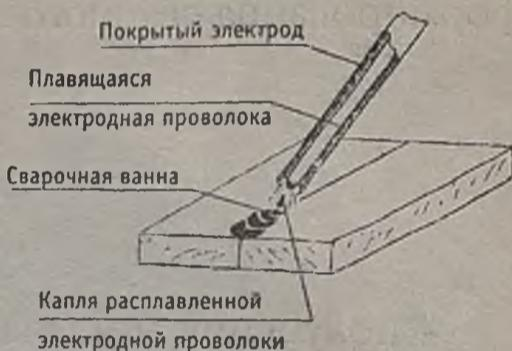
**Покрытие электрода** — смесь веществ, нанесенная на электрод для облегчения зажигания и стабилизации горения сварочной дуги, защиты сварочной ванны от вредных воздействий внешней среды, металлургической обработки сварочной ванны.
