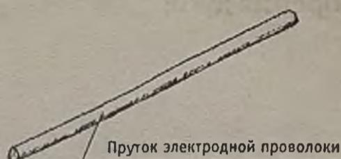
Электродная проволока выполняет роль присадочного материала, который, расплавляясь при сварке, образует металл сварного шва.
