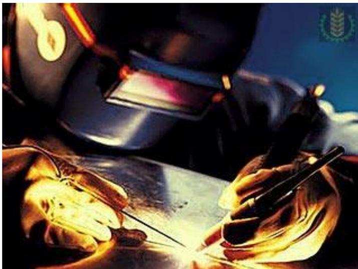
*Пайка*, в общем, по технологии и характеристикам сходна со сваркой, но отличается тем, что для пайки применяются специальные составы (припои), как правило на основе олова, свинца и флюсовых добавок. Наиболее широко пайка применяется в радиотехнике, электронике, при соединении деталей гидравлических систем (пайка трубок и штуцеров) и т.д.
